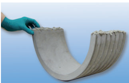
Spachtelmasse auf beide Halbschalen dick auftragen und Distanzhalter (im Lieferumfang enthalten) eindrücken (Abstand der Halbschalen 5 mm).
