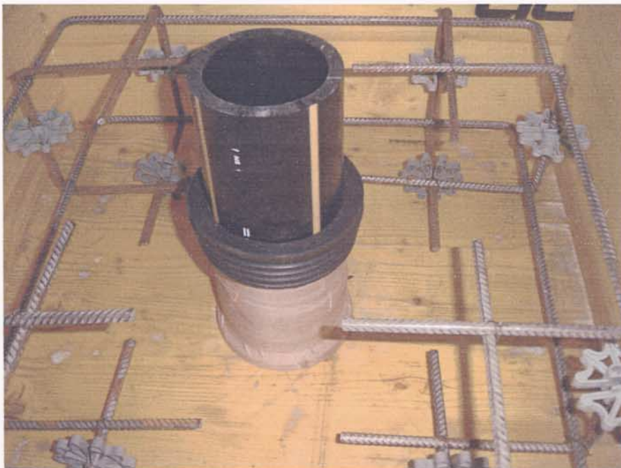
Bild 2: Mauerdichtring auf einem Polyethylen-Rohr braun: wasserdurchlässige Umhüllung zur Nachbildung einer Schwindfuge
