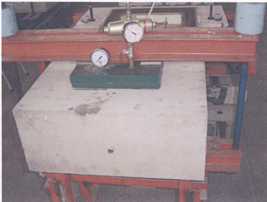
Bild 4: Probekörper unmittelbar vor Beginn der Prüfung der Druckwasserdichtigkeit
