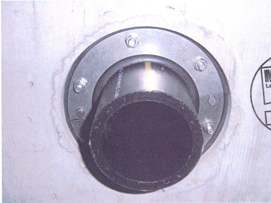
Bild 1: In den Prüfkörper eingebaute PSI Ringraumdichtung Compact DN 200 geteilt
