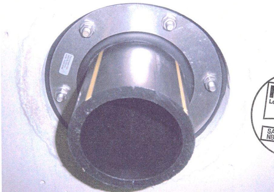
Bild 1: In den Prüfkörper eingebaute PSI Ringraumdichtung Compact DN 200 geschlossen
